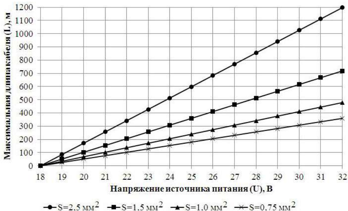
Рисунок 2 – Типовая зависимость максимально допустимой длины кабеля между газоанализатором и источником питания
